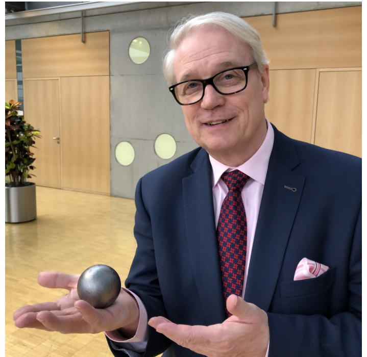
So sieht ein Brennelement eines Kugelhaufenreaktors aus, ein Reaktortyp, der in den Anfangsjahren des Kernkraftwerksbaus erprobt wurde, sich aber nicht durchsetzen konnte. In bestrahlter Form ist es hoch radioaktiv und muss in Deutschland nach Fertigstellung des Endlagers sicher entsorgt werden. Bis dahin befinden sich solche abgebrannten Elemente in hochgesicherten Zwischenlagern in speziellen Sicherheitsbehältern. (Foto: H.Häßler)
