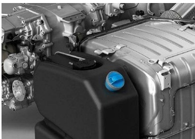
Moderne LKW haben seit einiger Zeit Systeme für Abgasnachbehandlung, Damit stoßen sie weniger NOx aus als die saubersten PKW. Das Bild zeigt ein SCR-Abgasreinigungssystem mit Harnstoffzufuhr der Firma Scania. (Bild: Scania)
